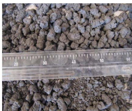
Рисунок 2.9 – Фотографія гранул, отриманих екструзією
