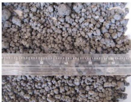
Рисунок 2.7 – Фотографія гранул, отриманих грудкуванням
