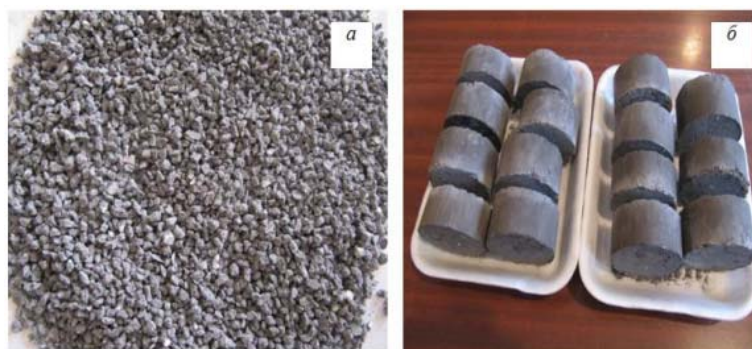
Рисунок 2.8 – Фотографія гранул, отриманих: а - дробленням брикетів (брикетне кришиво); б - вихідні брикети
