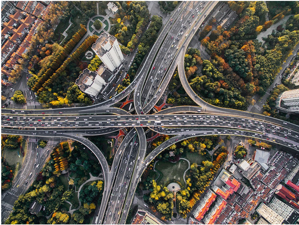
Рисунок 1.7 – Багаторівнева накопичувальна розв'язка. Перетин доріг Yan'an Elevated Road та Nanbei Elevated Road у Шанхаї (Китай). Шість рівнів.
