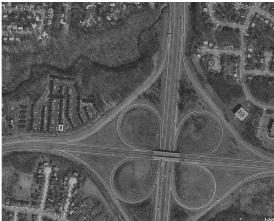
Рисунок 1.6 – Типова розв'язка «Листок конюшини», Колумбус, США
