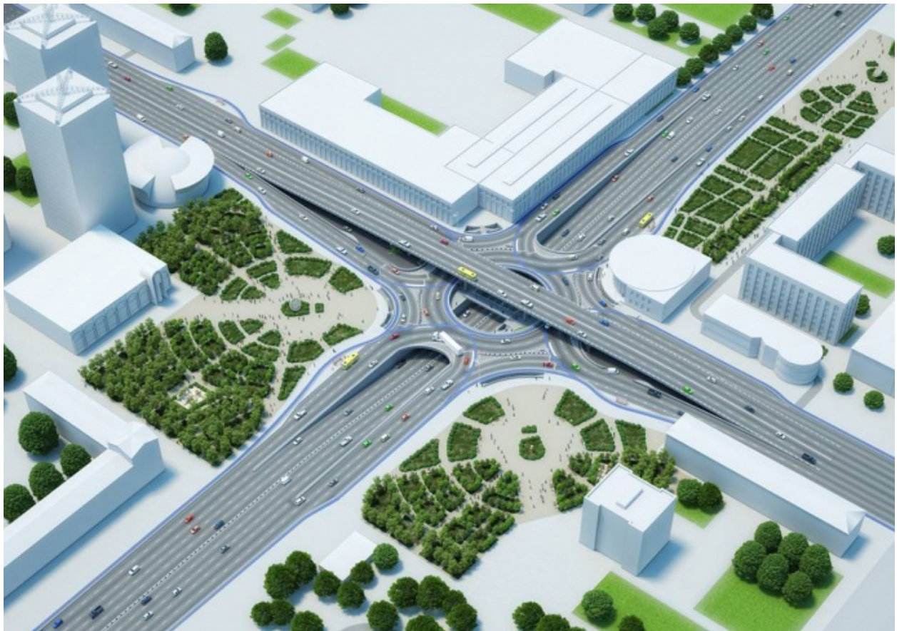
Рисунок 3.9 – Трирівнева транспортна розв'язка з реверсним розподільчим кільцем м.Київ, перетин проспекту Перемоги та вулиць Гетьмана і Довженка (вид зверху)
