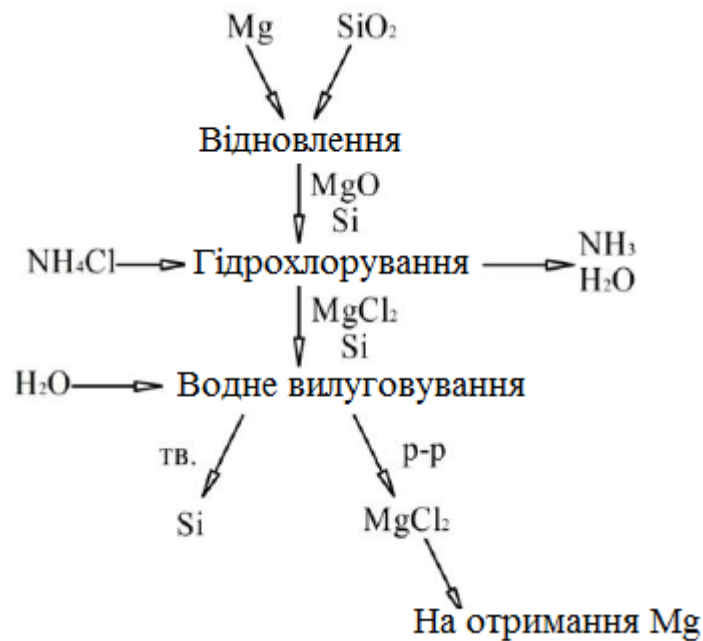
Рисунок 3.17 - Принципова схема отримання кремнію та відокремлення його від оксиду магнію при магнієтермічному відновленні діоксиду кремнію
