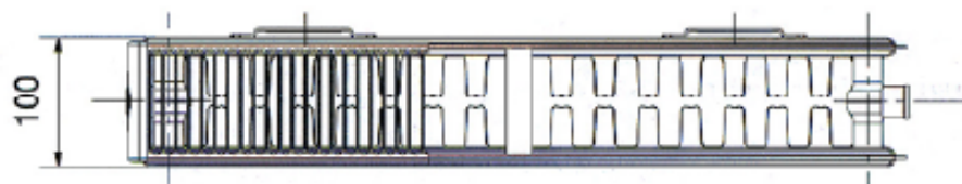
Рисунок 2.9 - Перетин радіатору RADIK типу 22
