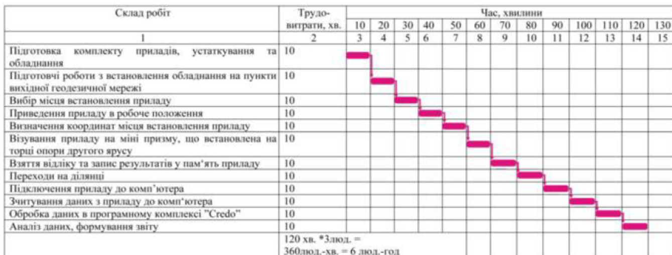
Рисунок 3.13 – Погодинний графік робіт з визначення планово-висотного положення опори другого ярусу трибун
