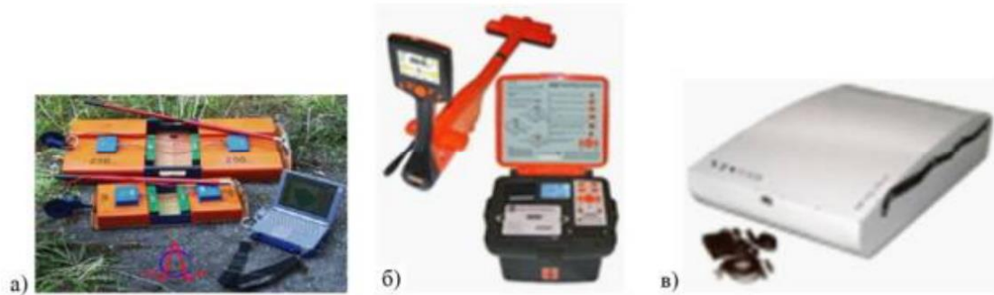
Рисунок 1.10 - Георадари та трасопошукові системи: а) георадар для пошуку у ґрунті (під водою) різних предметів, неоднорідностей (трубопроводів, карстових пустот тощо); б) трасопошукова система; в) локатор підповерхневого зондування
