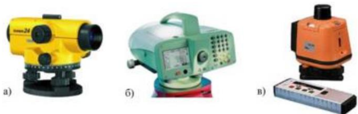
Рисунок 1.3. - Нівеліри: а) оптичний; б) електронний; в) лазерний
