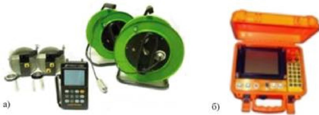
Рисунок 1.14 - Вимірювачі довжини та параметрів паль: а) ультразвуковий прилад для дефектоскопії буронабивних паль за допомогою перетворювачів, які занурені в контрольні канали; б) визначення довжини паль і локалізація дефектів (деформація профілю, тріщини)
