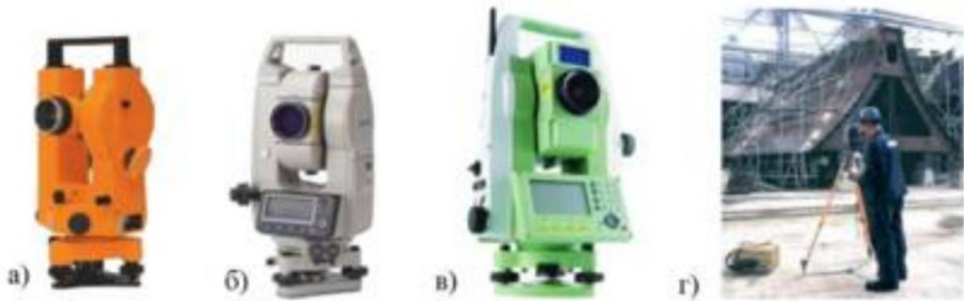
Рисунок 1.4. - Прилади для визначення просторового положення об'єктів: а) оптичний теодоліт; б) електронний теодоліт; в) електронний тахеометр; г) трьохкоординатна вимірювальна система MONMOS
