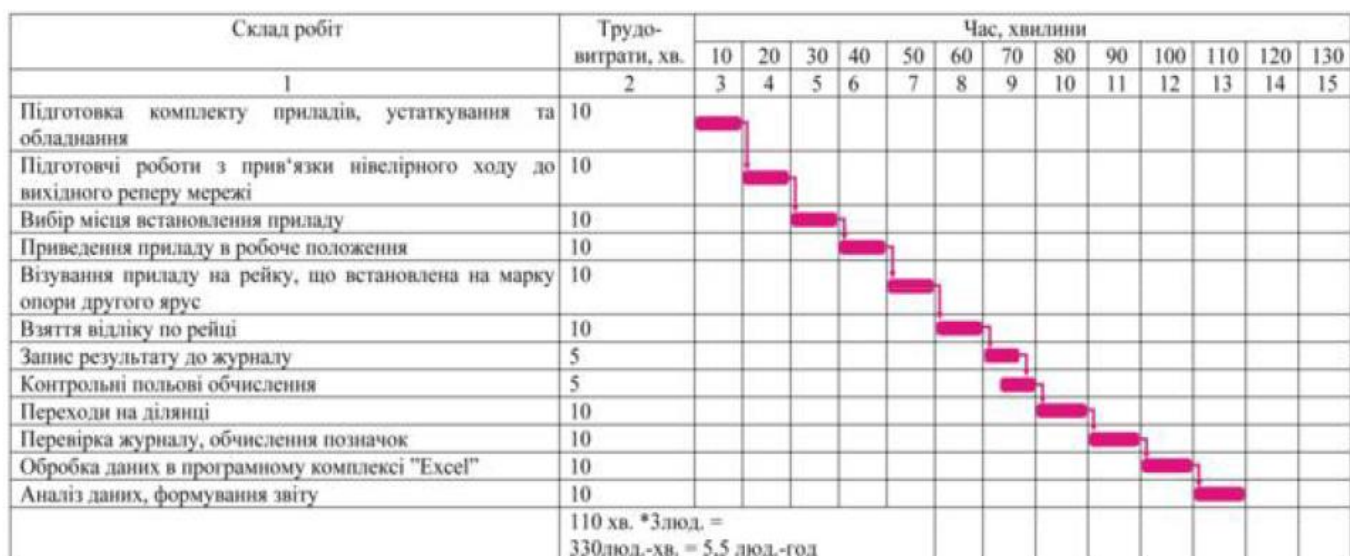
Рисунок 3.13 – Погодинний графік робіт з визначення планово-висотного положення опори другого ярусу трибун
