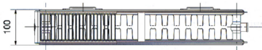
Рисунок 2.4 - Перетин радіатору RADIK типу 22
