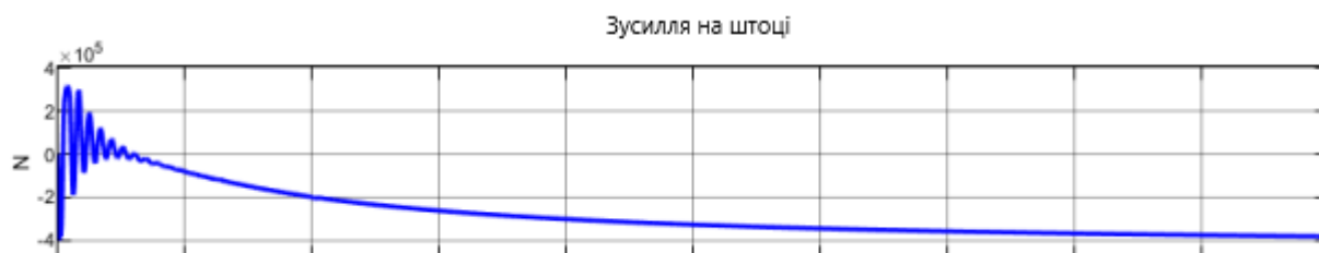
Рисунок 3.11 – Осцилограма зусилля на штоці
