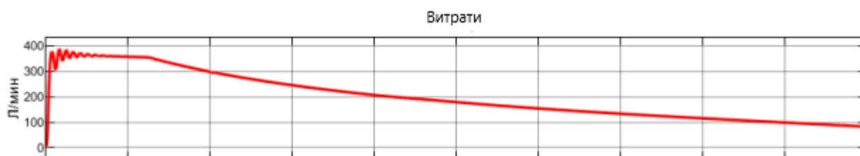
Рисунок 3.12 – Осцилограма витрат рідини
