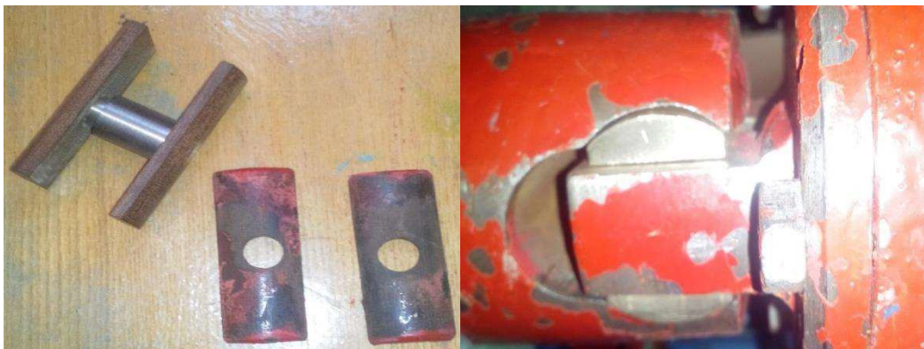
Рисунок 3.2 – Вкладиші універсального шпинделя лабораторного прокатного стану: а – текстолітові, б – бронзові
