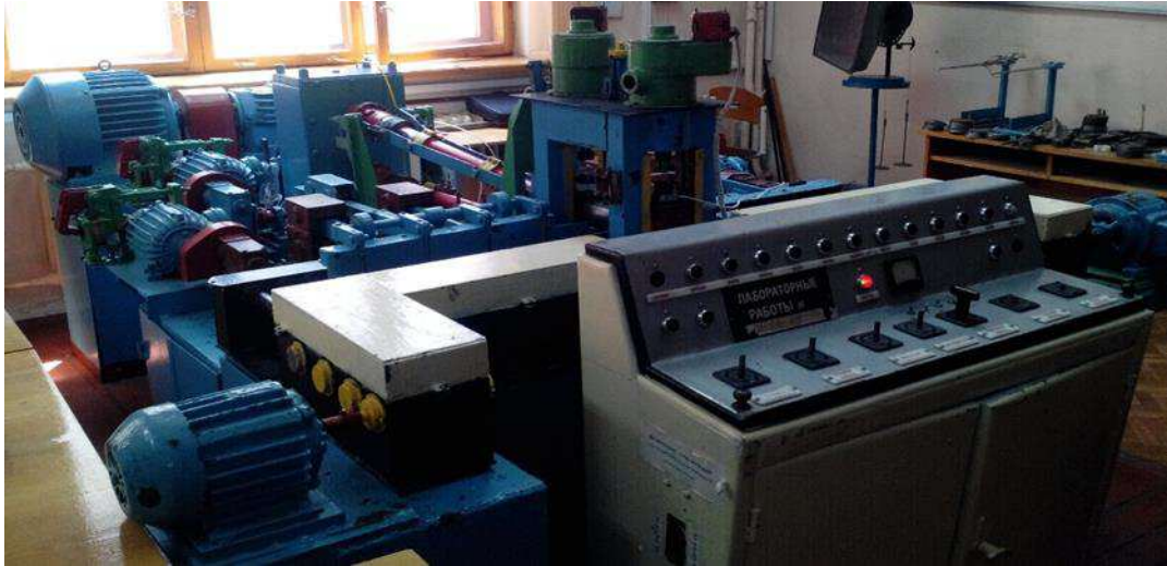
Рисунок 3.1 – Лабораторний прокатний стан з пультом керування
