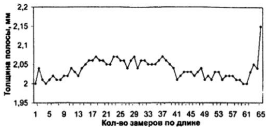
Рис. 3.2. Изменение толщины полосы 2 \times 1000 мм из стали марки Іпс, прокатаной с использованием Coilbox (длина сляба L = 9,3 м). (Данные меткомбината «Запорожсталь»)
