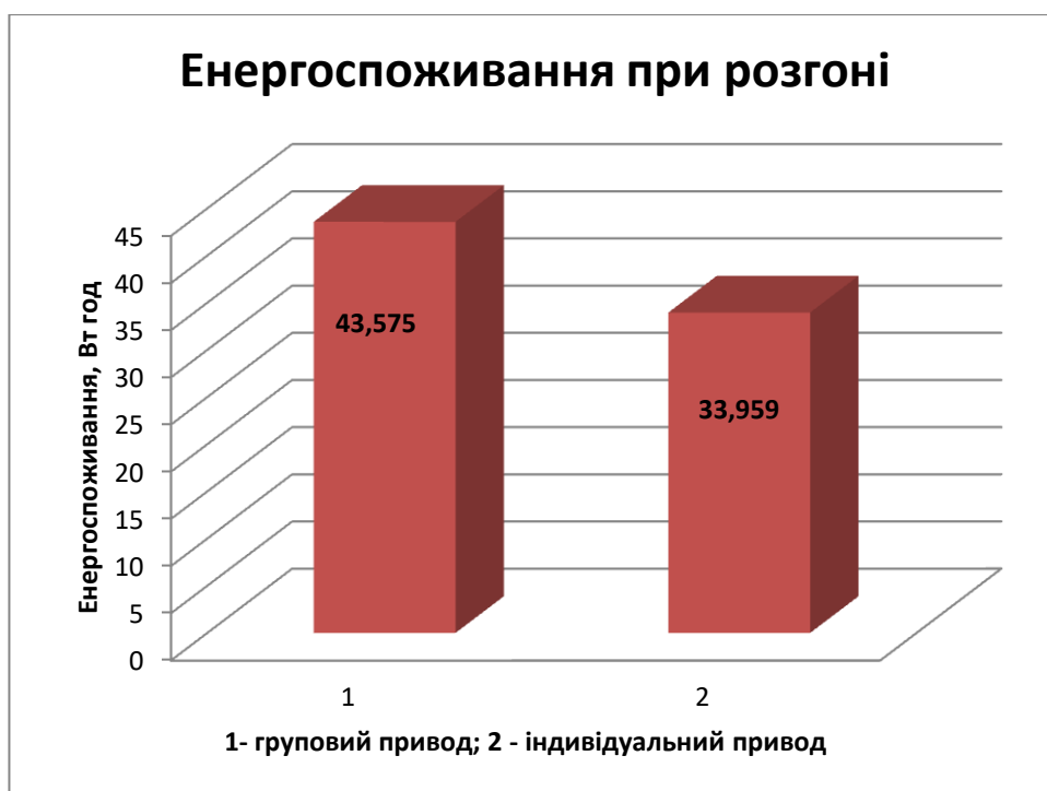
Рисунок 3.3 – Залежність енергоспоживання секції рольгангу при розгоні
