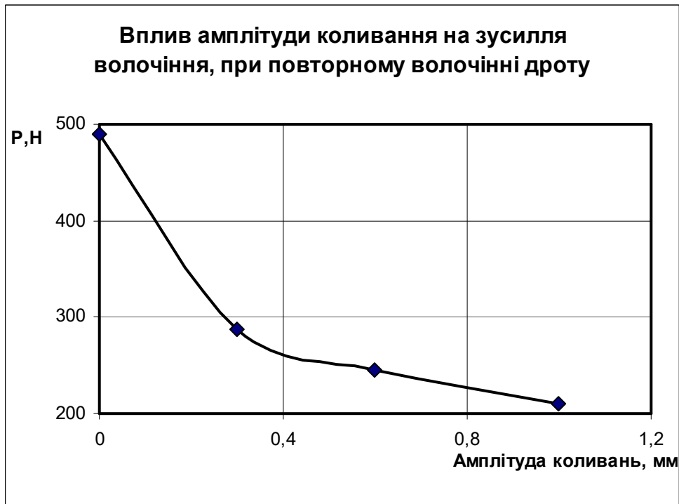
Рисунок 3. 7 - Вплив амплітуди коливань на зусилля волочиння, при повторному волочинні дроту.
