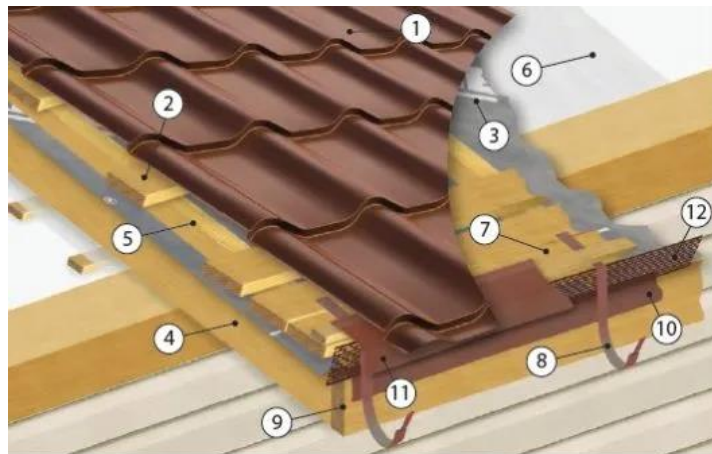
Рисунок 2.1 – Покрівля з металочерепиці:
