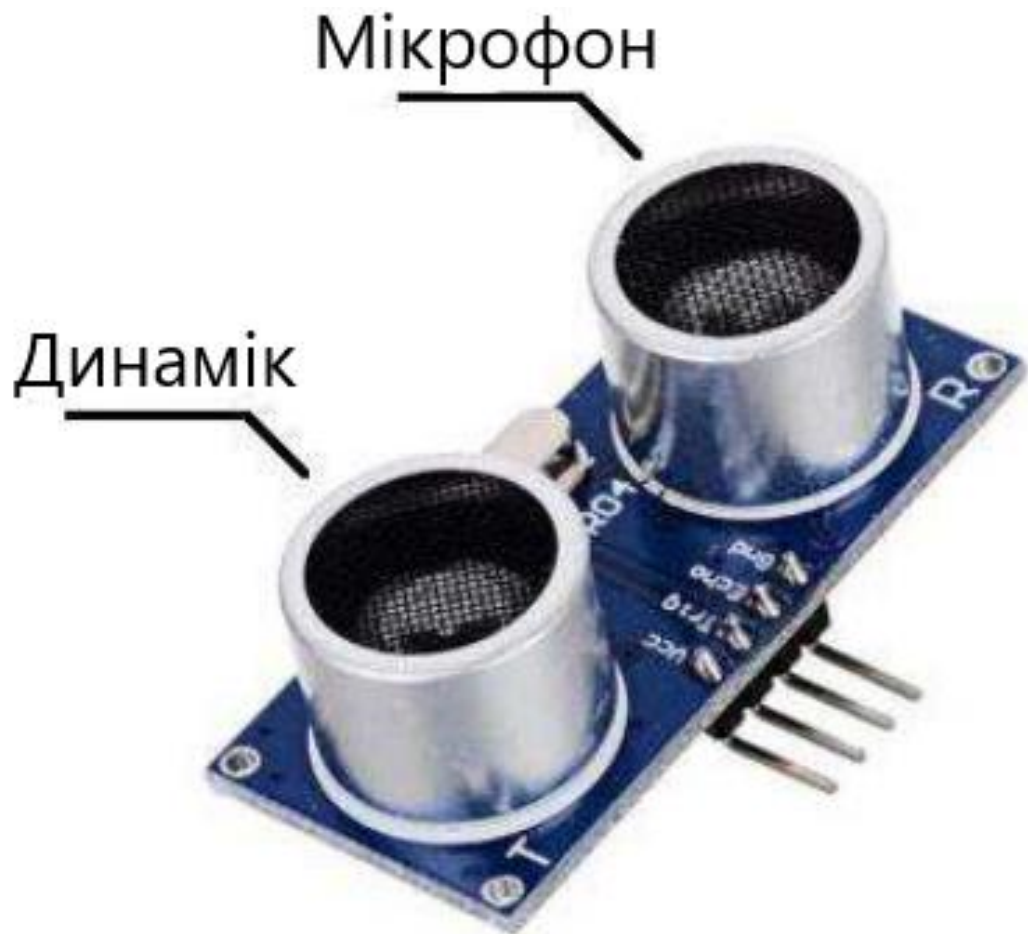
Рисунок 3.14 - Ультразвуковий датчик відстані HC SR04
