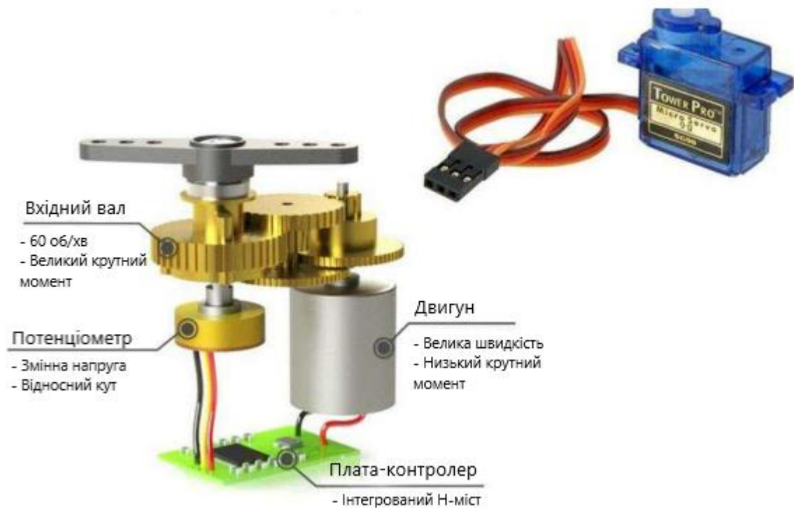
Рисунок 3.4 - Пристрій сервоприводу
