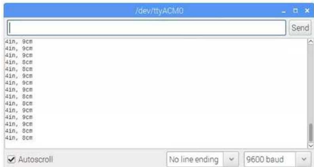
Рисунок 3.18 - Дані відстані до об'єкта в IDE
