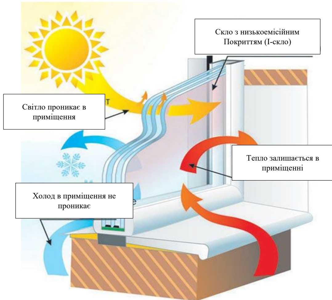
Рисунок 2.5 – Принцип роботи селективного скла
