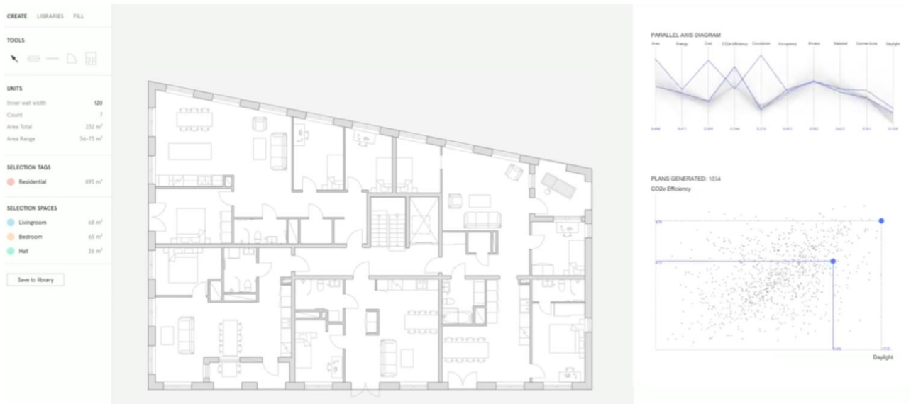
Рисунок 3.8 Генерація планових рішень на базі AI (Finch 3D)
