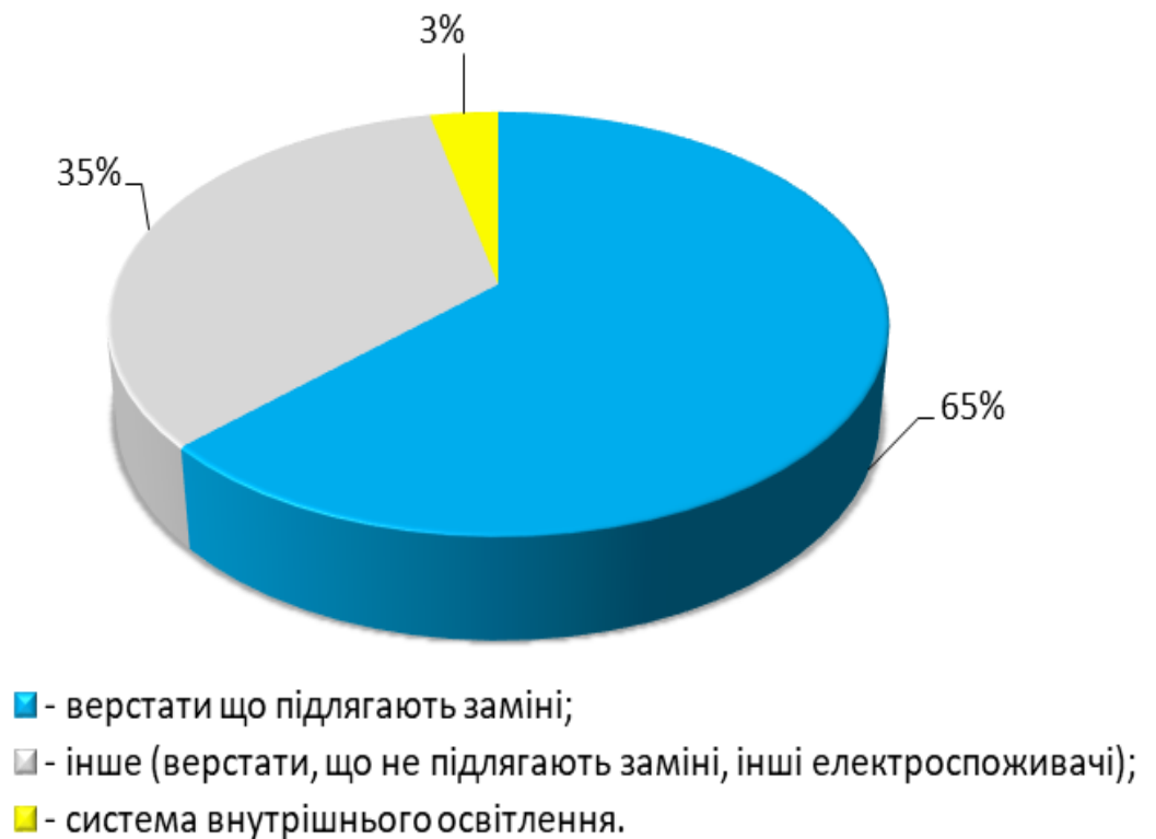
Рисунок 3.16 – Діаграма розподілу споживання електроенергії фрезерувальним цехом
