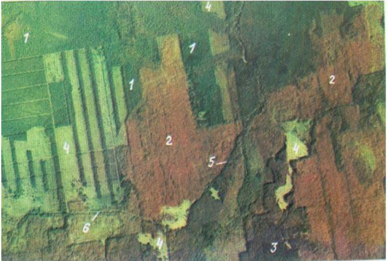
Спектрональний аерофотознімок (АФА-ТЕ/200, плівка СН-6М), масштаб 1 : 25 000 1 - соснові, 2 - березові, 3 - ялинові насадження, 4 - вирубки на різних стадіях відновлення, 5 - струмок, 6 - дорога
