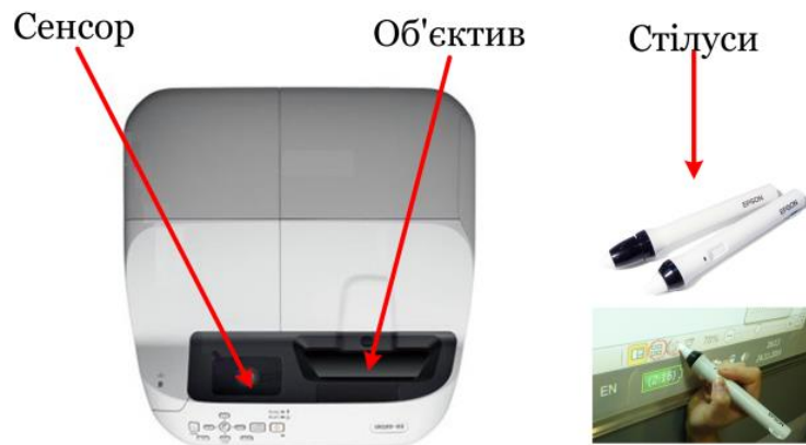
Рис. 2.4. Комплектація інтерактивного проєктора
