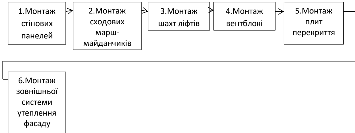
Рисунок 1.6 - Структурно-елементна схема вдосконаленої технології зведення типового поверху житлової багатоповерхової будівлі
