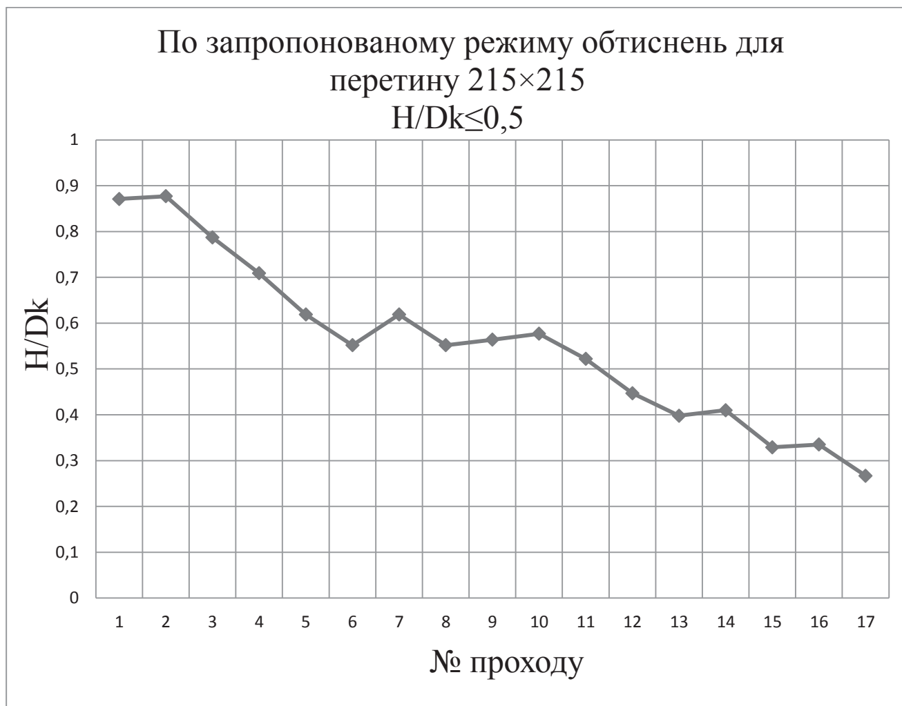
Рисунок 2.7 - Глибина проникнення деформації при прокатці металу (до табл. 2.3)
