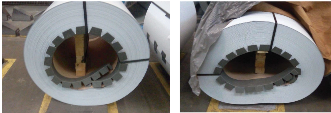
Рисунок 2.1 – Приклади просідання рулонів
