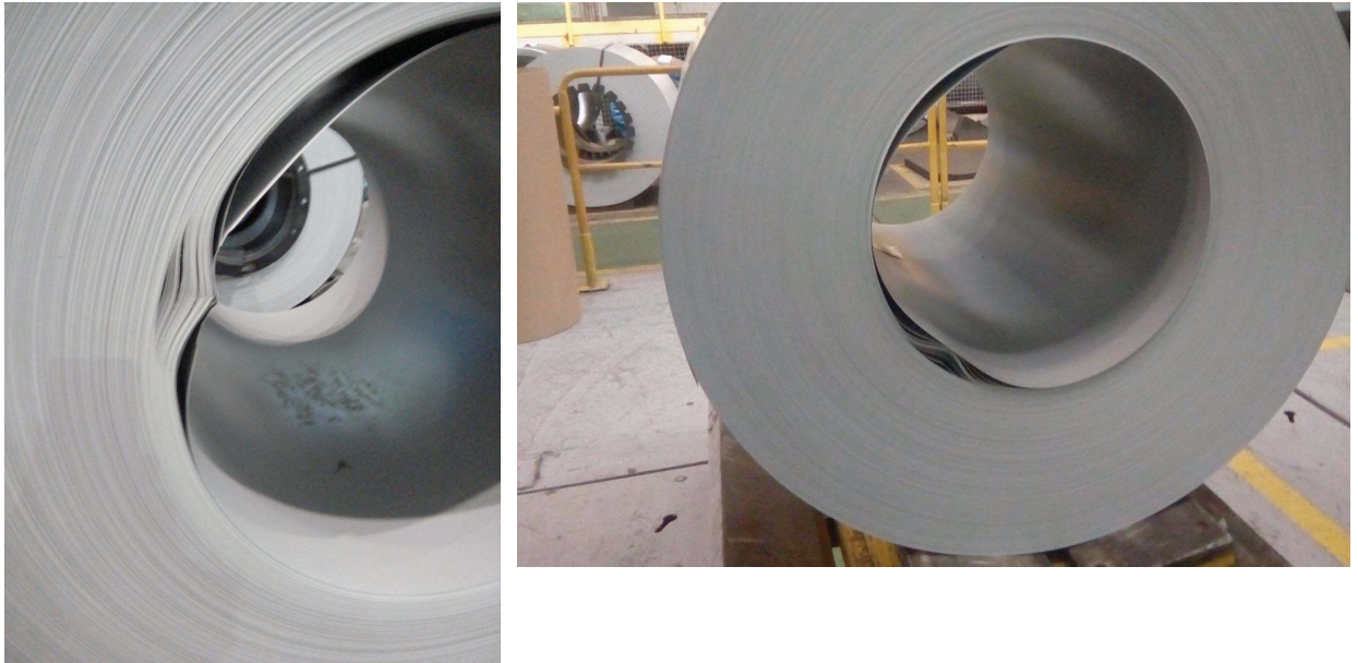
Рисунок 2.2 – Приклади виникнення дефекту «пташка»
