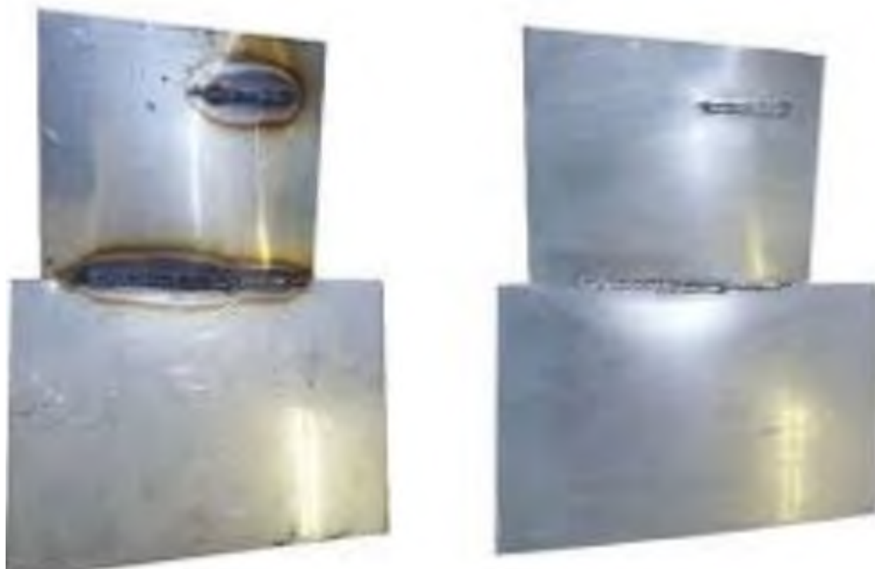
Рисунок 1.8 – Металева деталь (а) та лист після (б) до та після хімічного травлення [29]
