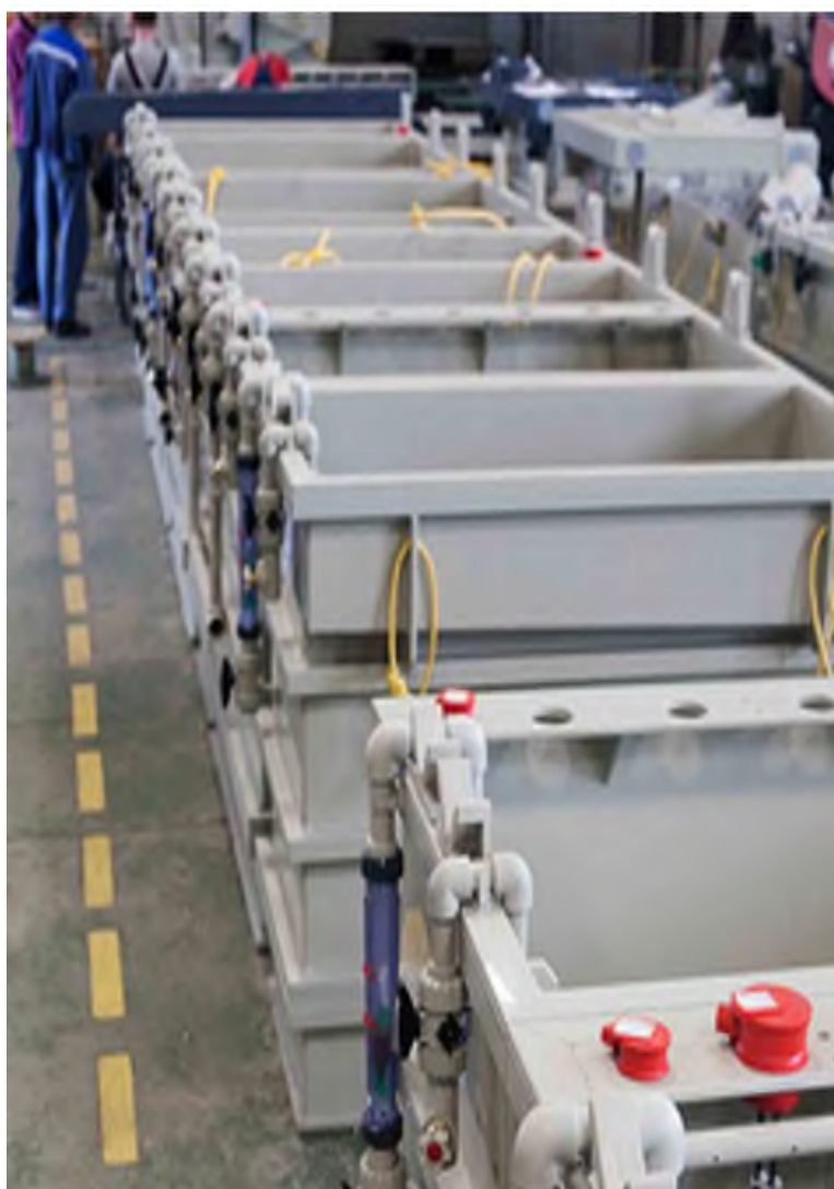
Рисунок 1.15 – Травильна ванна FORTEX - Water Technologies (Республіка Беларусь) [32]
