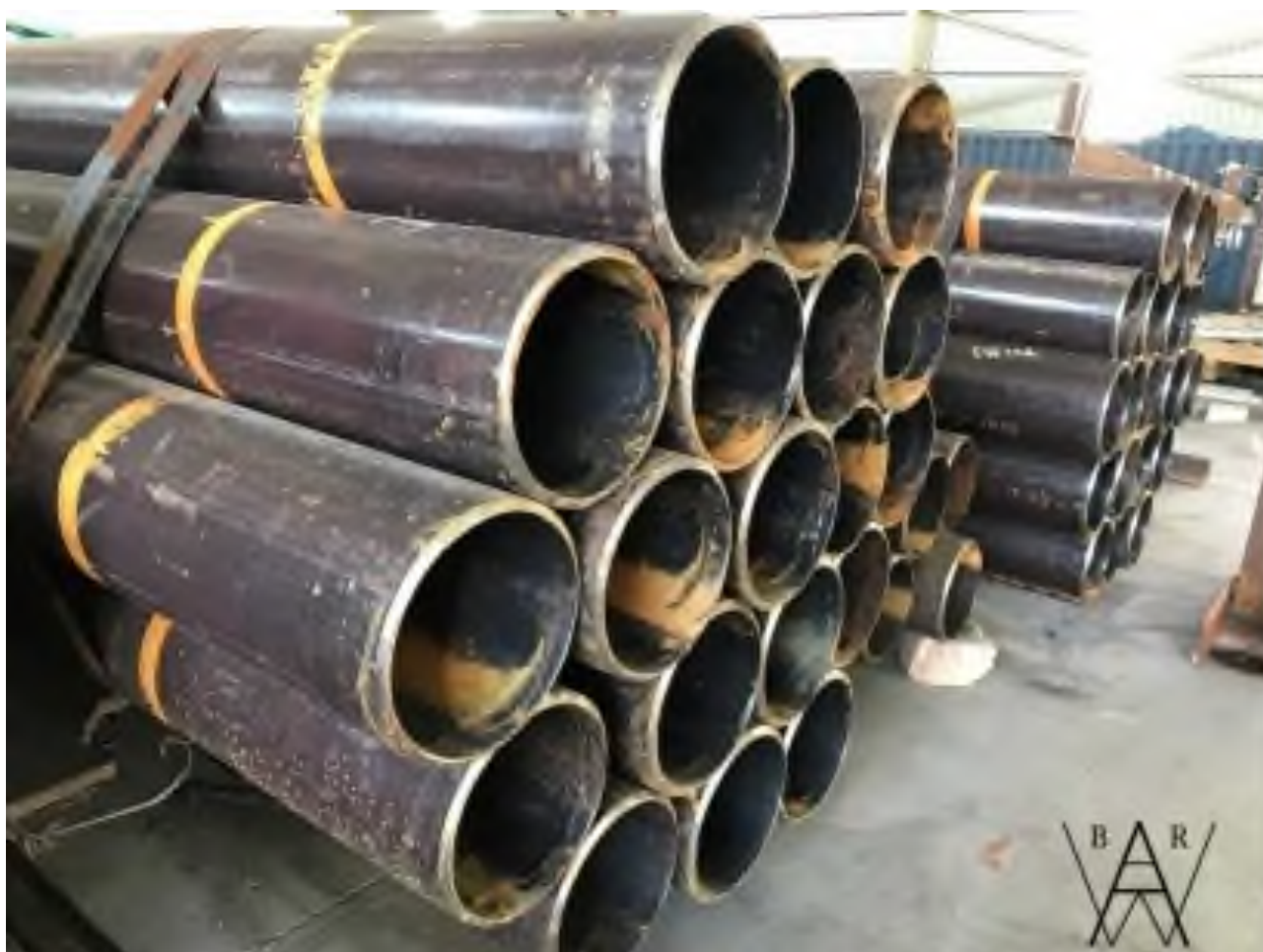
Рисунок 1.4 – Сталеві труби зі сталі 40X (розмір 146x17 мм)
