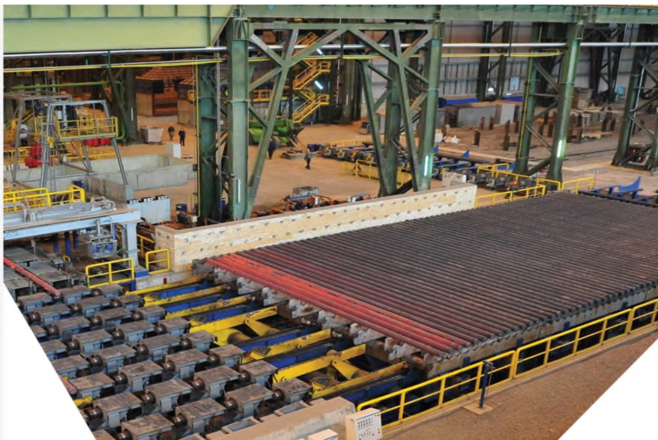
Рисунок 2.5 – Машина безперервного лиття заготовок криволінійно-радіального типу
