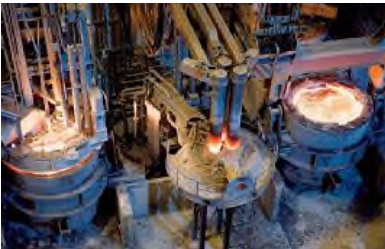
Рисунок 2.4 – Загальний вигляд установки піч-ківш з плазменим нагрівом
