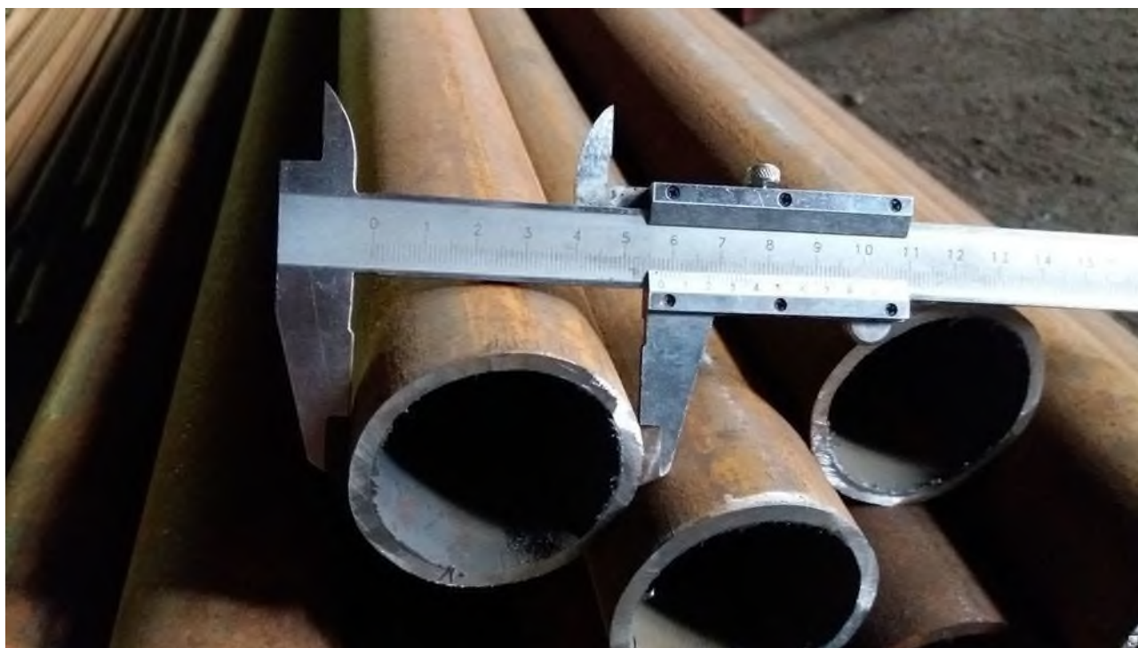
Рисунок 1.3 – Сталеві труби зі сталі 20 (розмір 114x5 мм)
