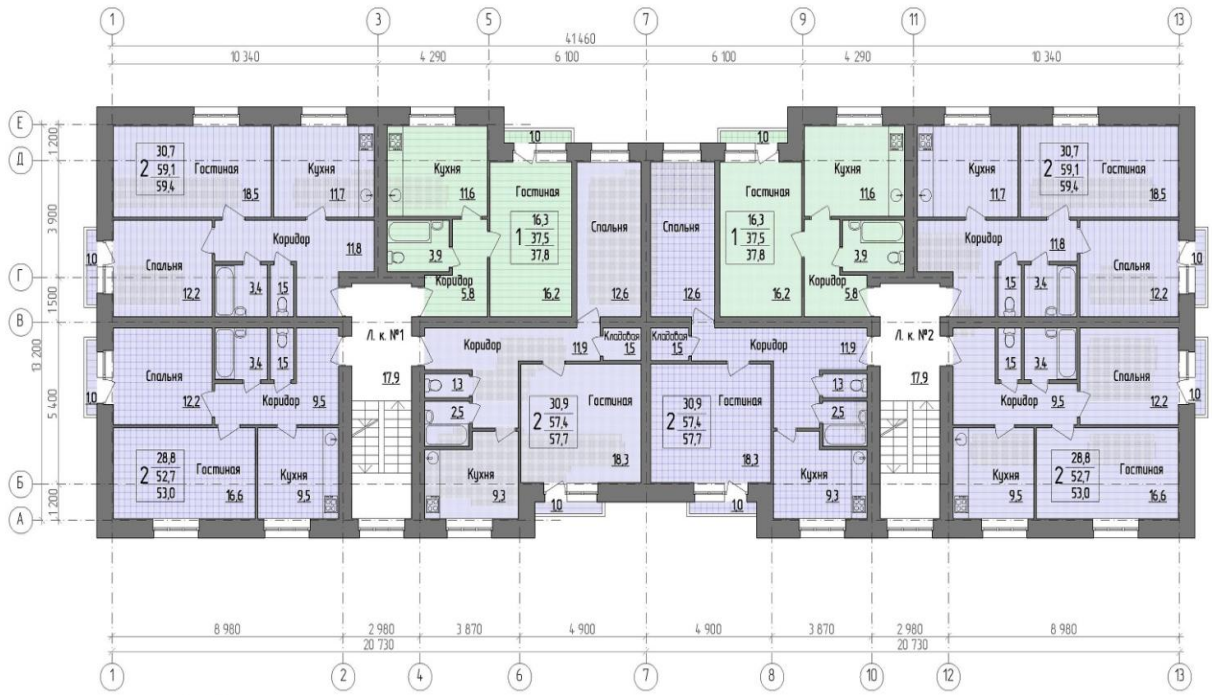
Рисунок 1.1 – Секційний тип об’ємно-планувальної структури житлового будинку
