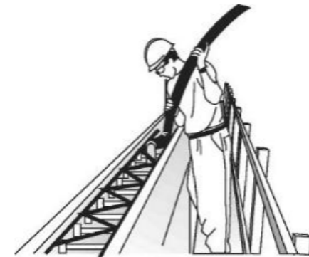
Рисунок 3.6 - Укладання бетону з подачею бетононасосом 2-го ярусу бетонування
