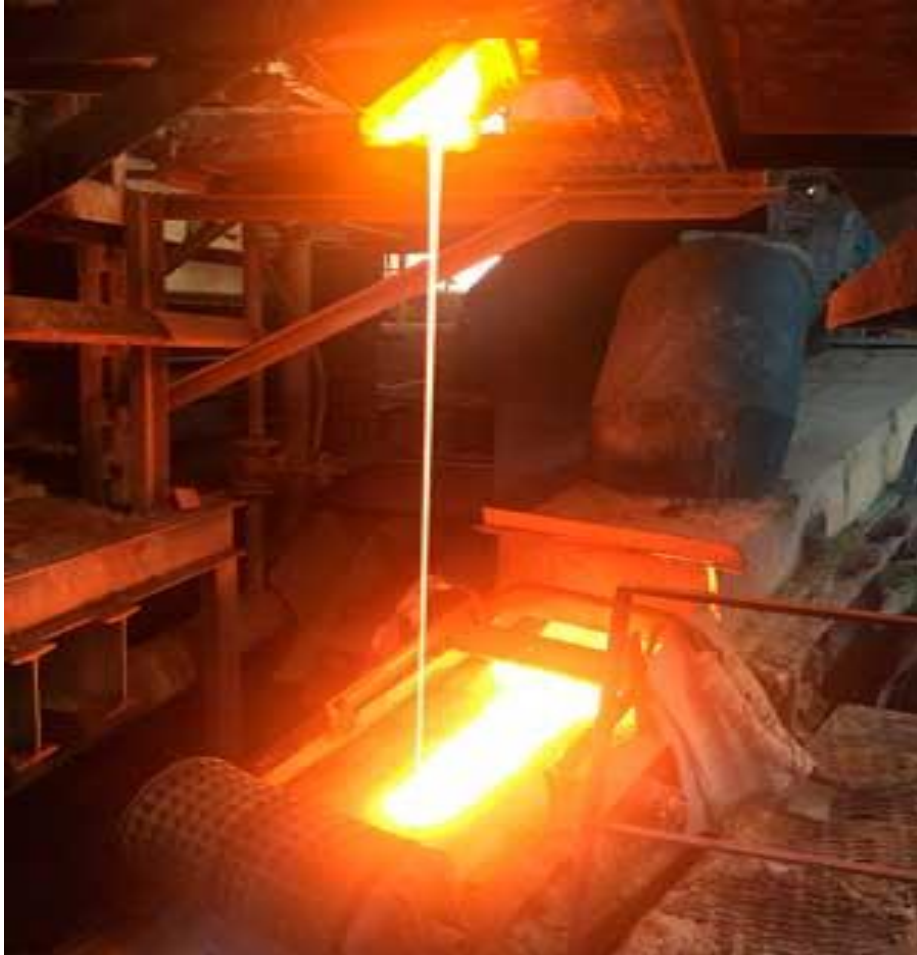
Рис. 2.2. Обладнання з виробництва зварювальних флюсів методом подвійного рафінування розплаву
