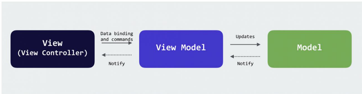
Рисунок 5 — Схема архітектури MVVM
