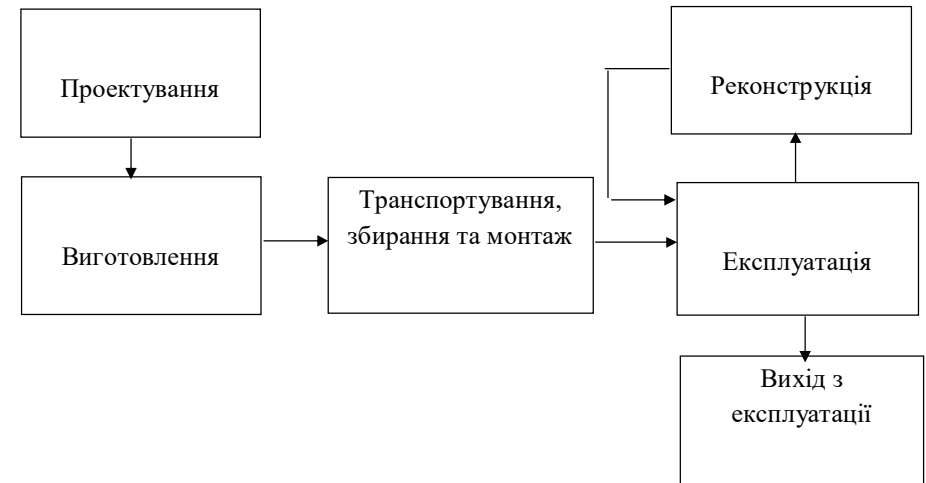
Рисунок 1.1 - Етапи життєвого циклу будівель і споруд
