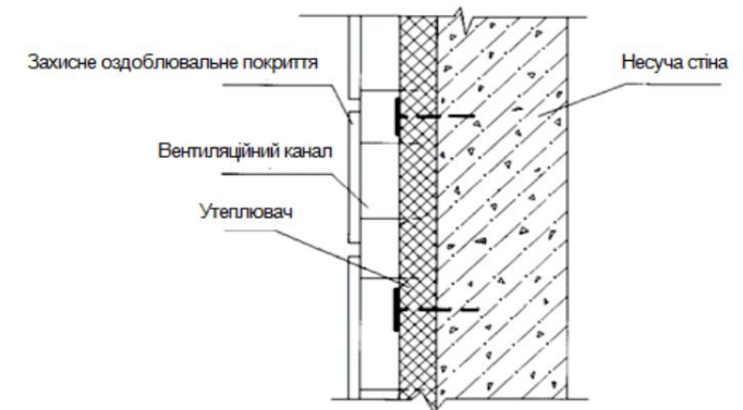
Рисунок 3.13 - Утеплення стін за методом «керамічний вентиляований фасад»
