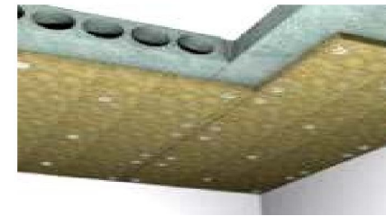
Рисунок 3.15 - Утеплення перекриття зі сторони підвалу
