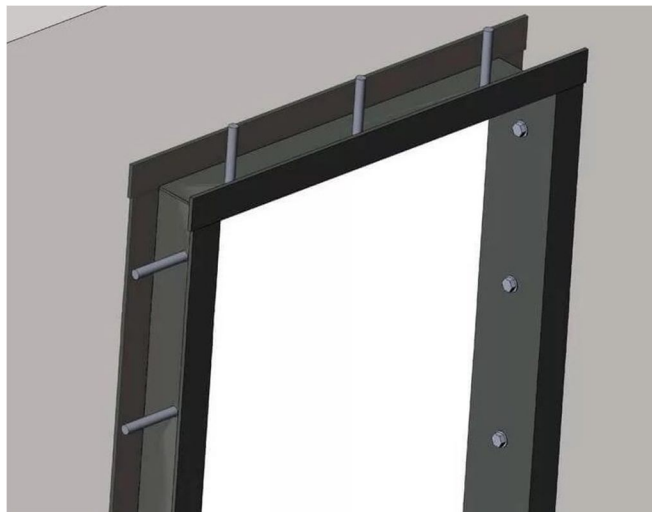
Рисунок 22 - Однорядне армування за допомогою швелерів.
