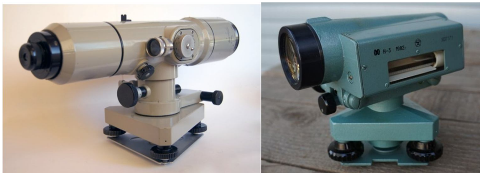
Рисунок 9 - Прилади для нівелірування типу Н1, Н3
