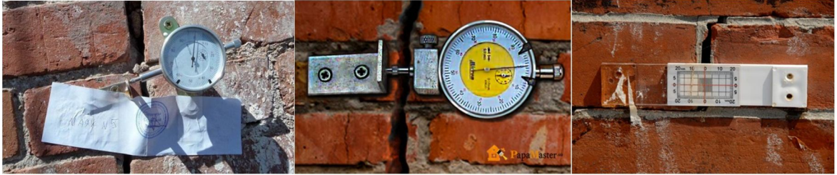
Рисунок 14 - Види маяків для виміру тріщин
