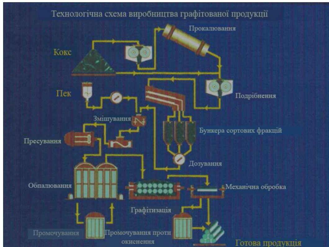
Рисунок 1.1 - Технологічна схема виробництва графітової продукції
