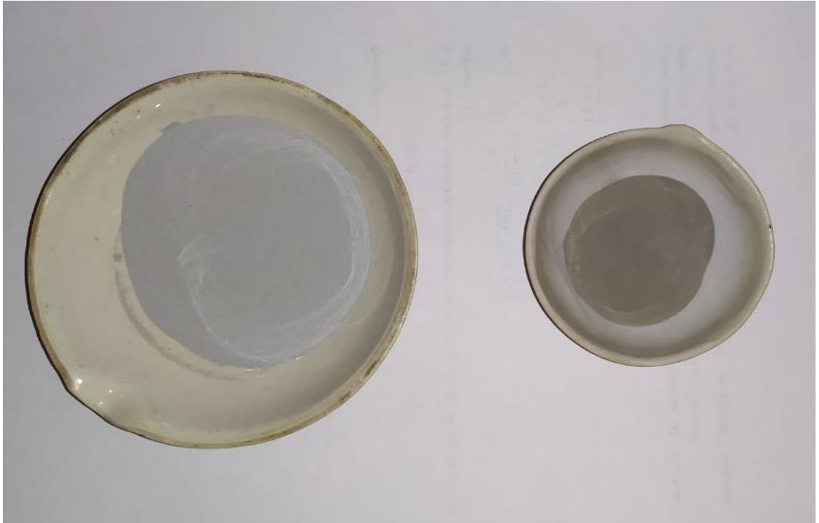
Рисунок 3.2 – Зважені порошки алюмінію і нікелю для подальшого їх пресування на лабораторному пресі ПСУ-125
