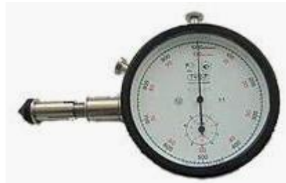
Рисунок 1.3 - Схема напівавтоматичного годинникового тахометра типу ТЧ 10-Р1
