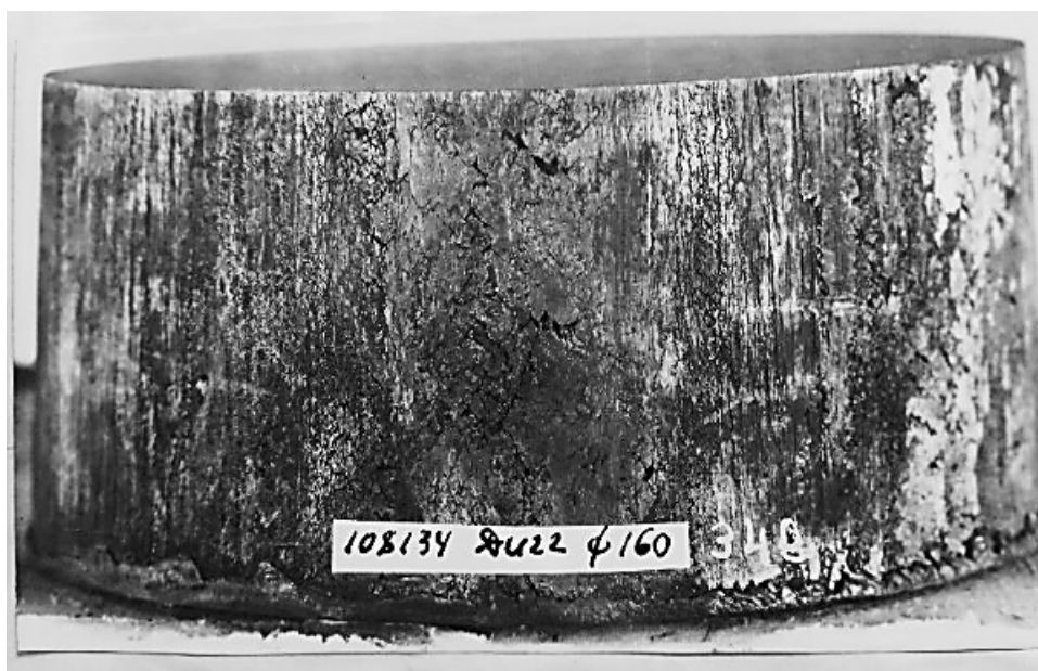
Рисунок 1.3 – Рванини, що утворилися в процесі прокатки на ребрах проміжних смуг на круглому сорті зі сталі 4Х4М2ВФС
