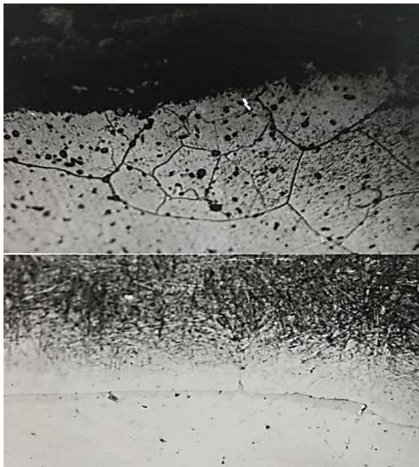
Рисунок 2.5. – Мікроструктура сталі 4X4M2BFC в поверхневій зоні зливка P = 1,0 т після нагріву при 1250 °С протягом однієї години
