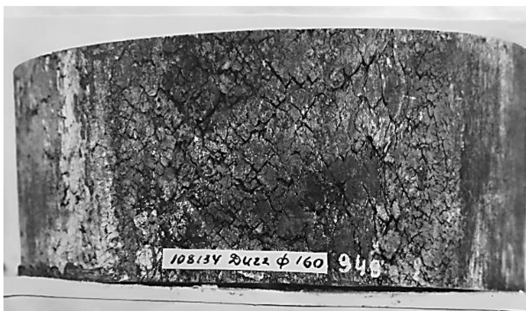
Рисунок 1.4 – Рванини, що утворилися на гранях проміжних смуг на круглому сорті зі сталі 4Х4М2ВФС, утворилися при прокатці.
