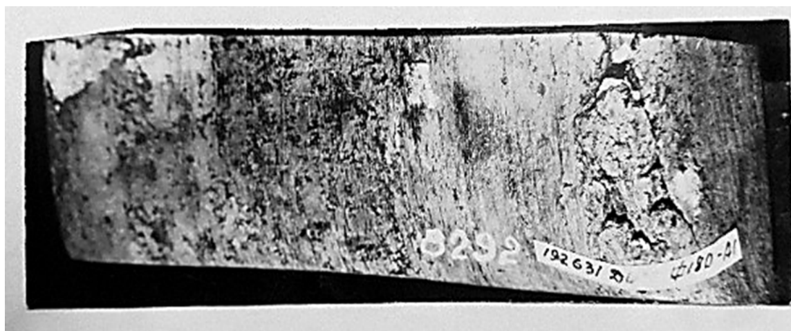
Рисунок 1.1 – Рванини, що утворилися на ребрах розкату на заготівлі зі сталі 4Х4М2ВФС
