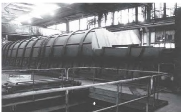
Рисунок 1.12- Агломераційна стрічка з укриттям відповідно до процесу EOS (викиди при оптимізованому спалюванні)
