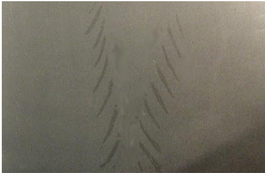
Рисунок 3.5 – Дефект «смуги-лінії ковзання»
