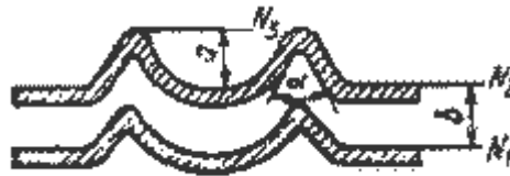
Рисунок 2.2 – Схема викривлення інтерференційних ліній
