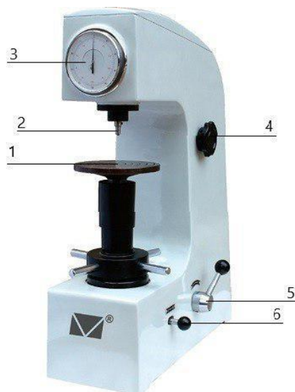
Рисунок 2.5 – Твердомір «Роквелл» модель HRA-1: 1-робочий стіл; 2-індентор; 3- індикатор; 4- ручка перключення навантаження; 5- ручка розвантаження; 6- ручка навантаження
