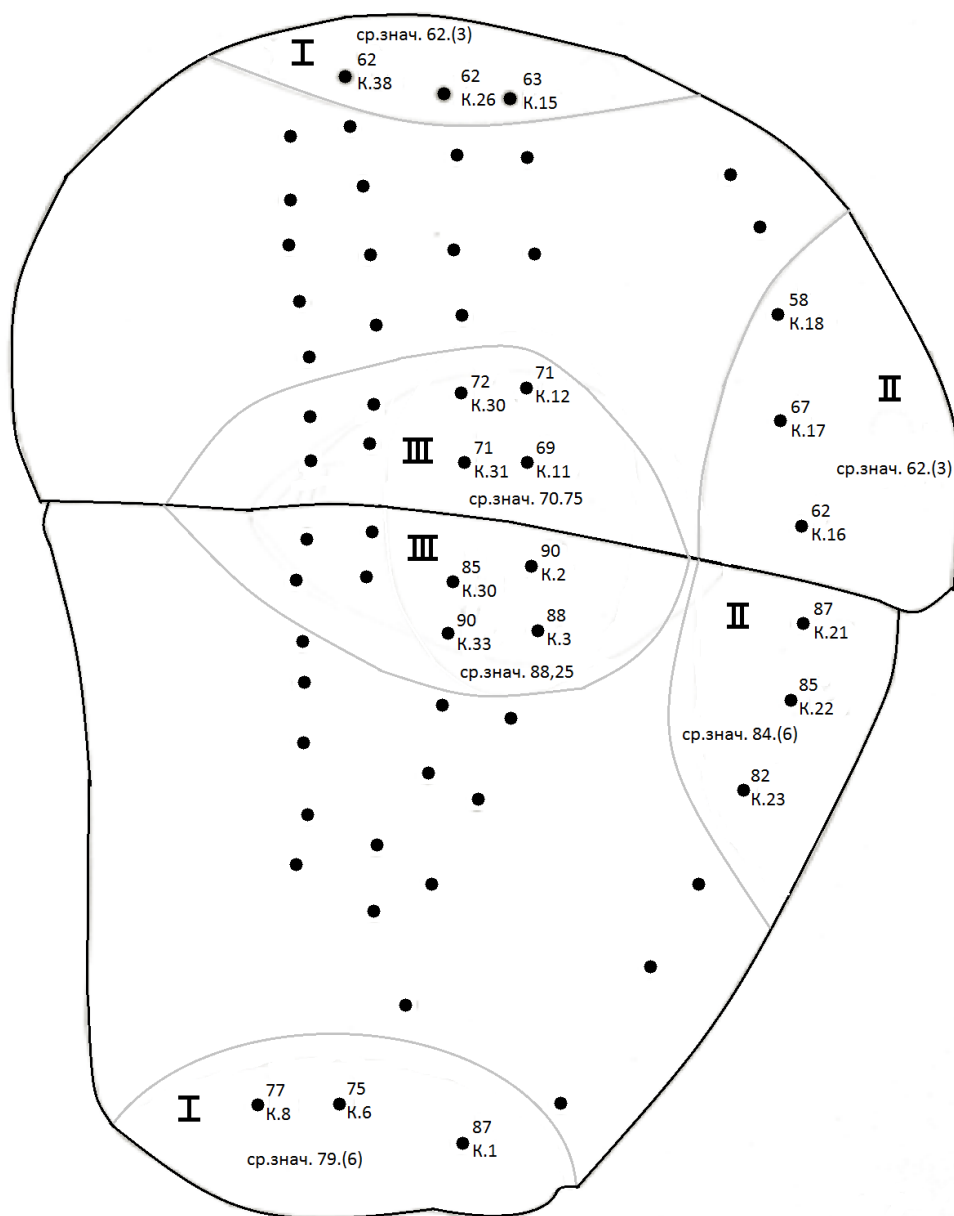
Рисунок 3.1 – Розподіл твердості по перерізу біметалевої заготовки (сталь 10ХФТч + 12Х16Н13МБч) після деформації \epsilon=50\% при 1100^{\circ}\text{C} , I – зона гальмування деформації; II – зона ускладненої деформації; III - Зона інтенсивної деформації; IV - зона термічного впливу
