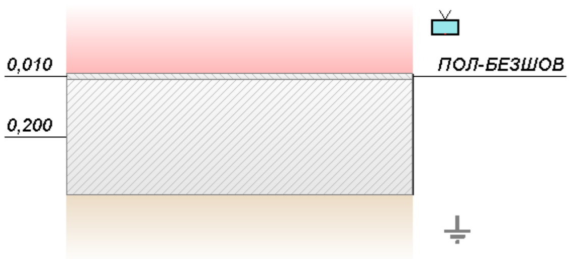
Рисунок 2.2 – Матеріали підлоги по ґрунту для неопалювального підвалу
