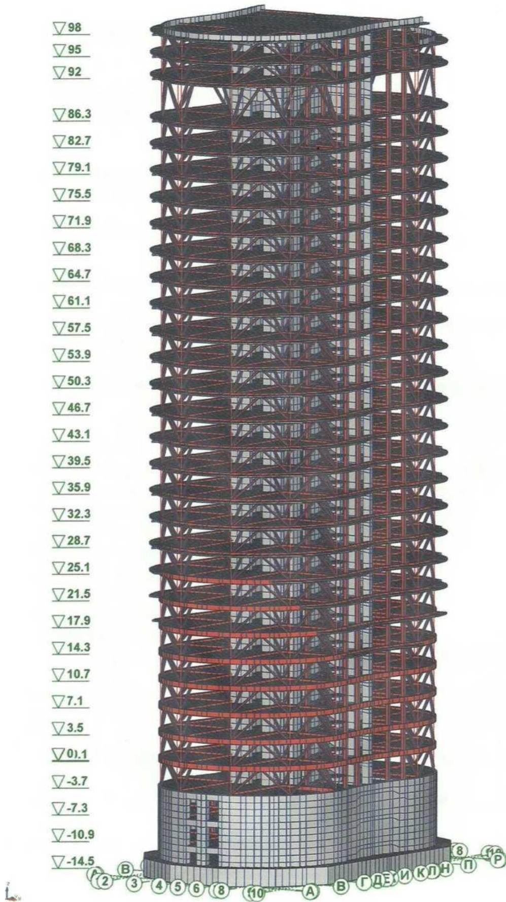
Рисунок 2.5 - Розрахункова схема будівлі ЖК «Сайран»
