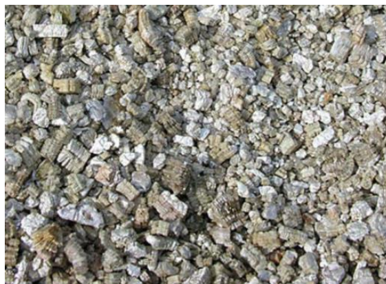
Рисунок 1.13 – Теплоізоляційний матеріал з вермікуліту
