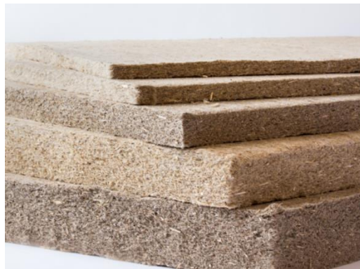
Рисунок 1.10 – Теплоізоляційний матеріал з конопляних рослин
