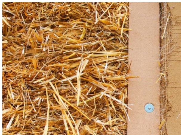
Рисунок 1.9 – Теплоізоляційний матеріал з солом'яних тюків
