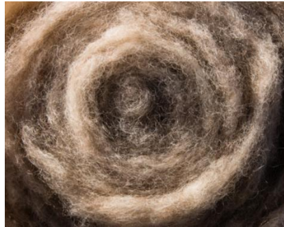
Рисунок 1.8 – Теплоізоляційний матеріал з вівчаної шерсті (овеча вовна)
