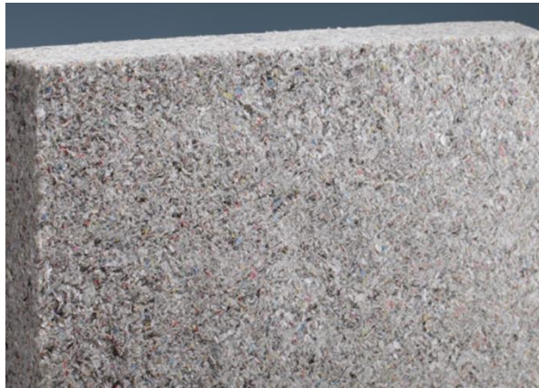
Рисунок 1.6 – Теплоізоляційний матеріал целюлозна ізоляція
