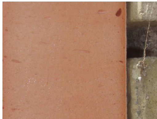
Рисунок 1.16 – Теплоізоляційний матеріал з фенолформальдегідної піни
