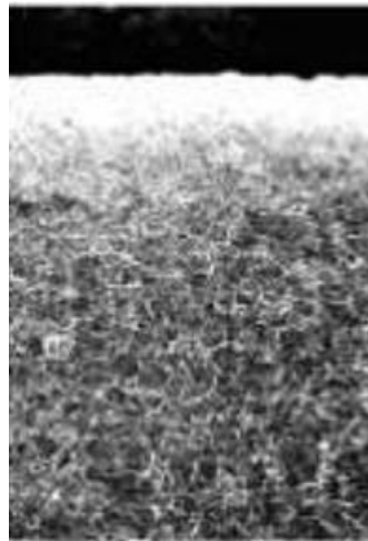
Рисунок 1.3 – Мікроструктура дифузійного шару сталі 40X12P8Г8МФБ після комбінованої хіміко – термічної обробки, \times 100 [18, с. 56]
