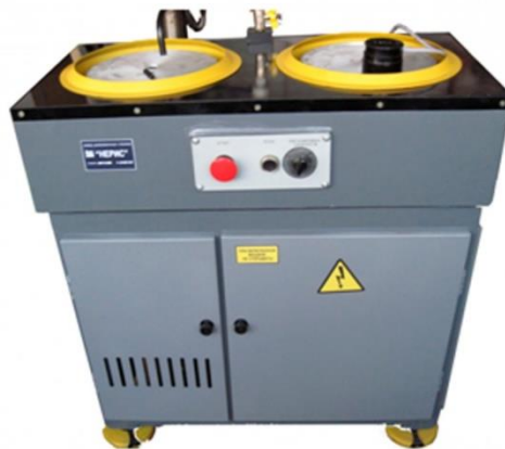
Рисунок 2.1 – Шліфувально-полірувальний стан марки Neris 3E881 [39, с.115]
