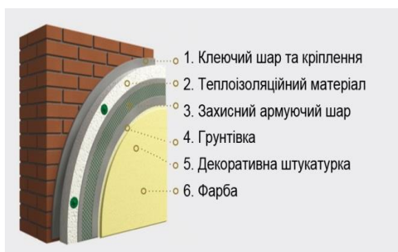
Рисунок 2.11 – Система скріпленої теплоізоляції
