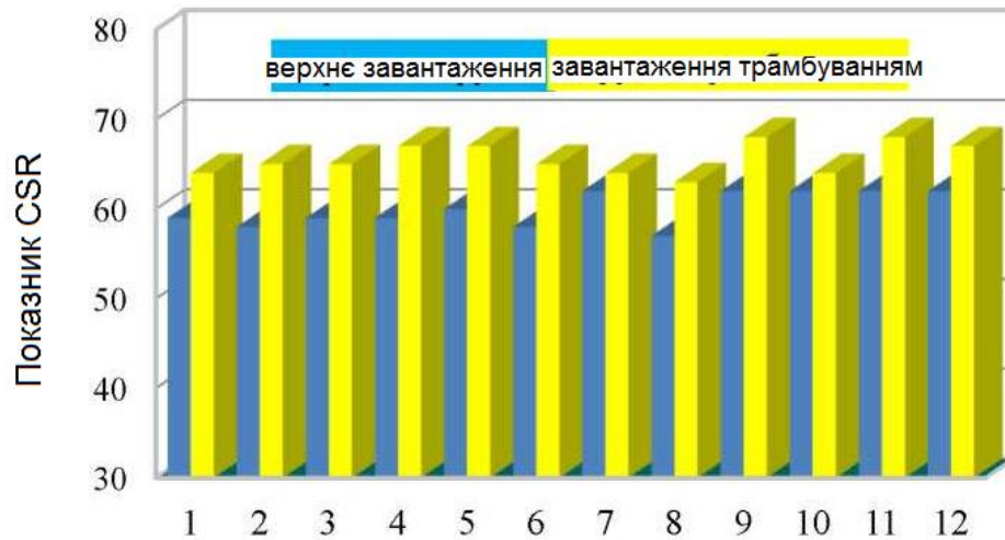
Рисунок 3.2 - Показник CSR на печах з вертикальним завантаженням і завантаженням з трембуванням [9]
