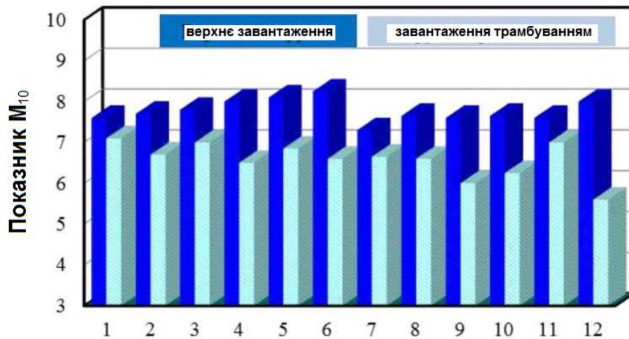
Рисунок 3.3 - Показник M10 на печах з вертикальним завантаженням і завантаженням з трембуванням [33]
