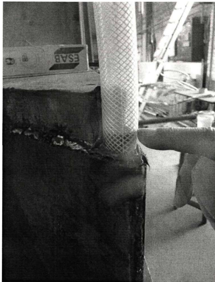
Рисунок 3.13 - Рівень бетонної суміші в полімерній прозорій трубці
