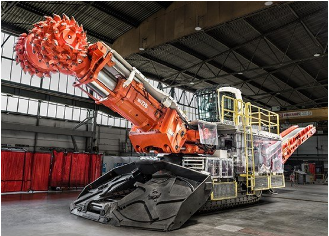
Рисунок 1.2 - Гусеничний прохідницький комбайн з електроприводом.
