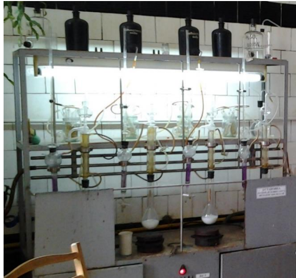
Рисунок 2.4 – Схема установки для визначення нітрогену в струмі інертного газу аргону
