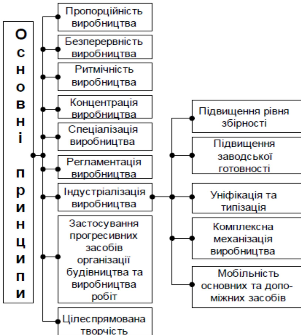
Рисунок 1.1 - Основні положення (принципи) організації будівельного виробництва
