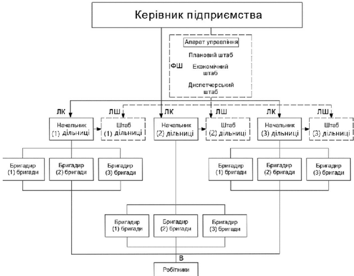
Рисунок 1.5 – Лінійно-штабний тип структури управління будівельними організаціями: ФШ – функціональний штаб (апарат управління); ЛК – лінійний керівник; ЛШ – лінійний штаб; В – виконавець.
