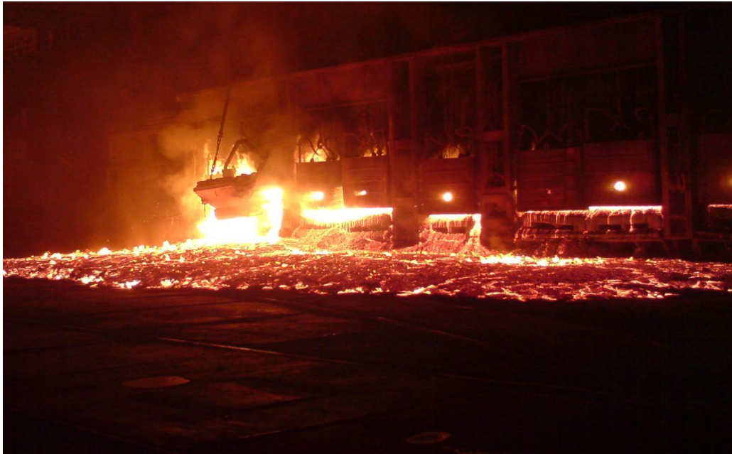
Рисунок 1.2 – Процес виплавки мартенівської сталі
