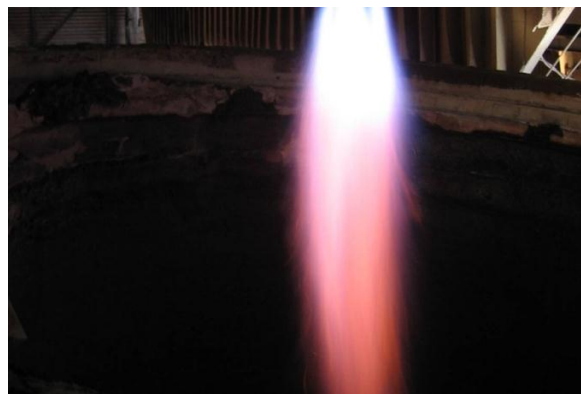
Рисунок 3.2 – Горіння короткого факелу при коливанні тиску газу
